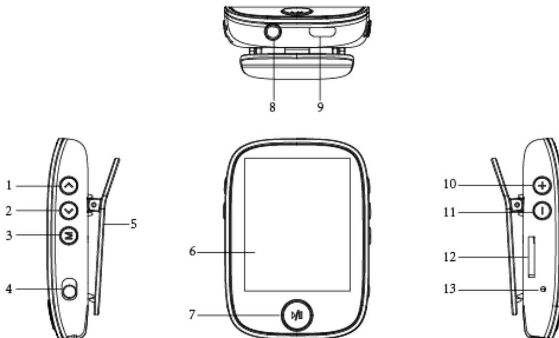
1、 Backward 2、 Forward 3、 MENU 4、 Power on/off 5、 Clip 6、 LCD display 7、 Play/ Pause 8、 Earphone jack 9、 USB port 10、 VOL+ 11、 VOL- 12、 Micro SD slot 13.MIC
